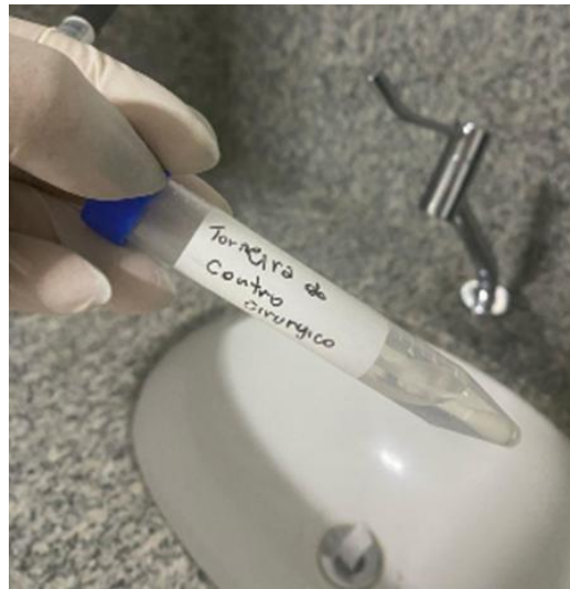
Figura 2: Coleta da amostra do biofilme da torneira do centro cirúrgico
