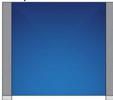
Figura 1 – Representação esquemática do modelo 2D acoplado fluido estrutura
