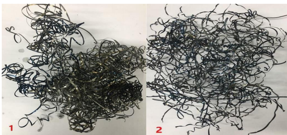
Figura 2 - Formação de cavaco. 1: com fluido; 2: sem fluido.
