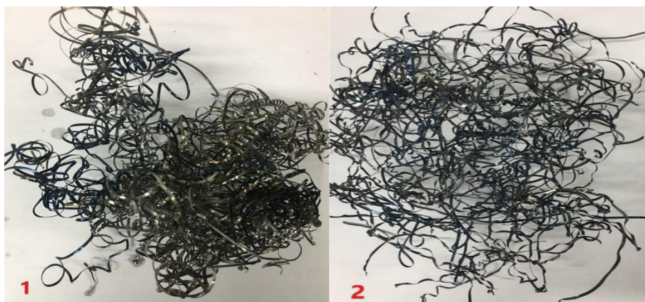
Figura 1 – Formação de cavaco. 1: com fluido; 2: sem fluido.
